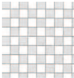
Exemple de pose à joints alignés (à proscrire)
